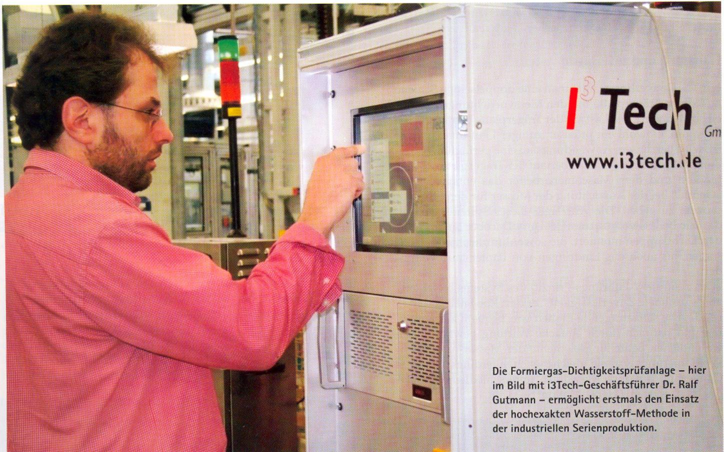
Die Formiergas-Dichtigkeitsprüfanlage – hier im Bild mit i3Tech-Geschäftsführer Dr. Ralf Gutmann – ermöglicht erstmals den Einsatz der hochexakten Wasserstoff-Methode in der industriellen Serienproduktion.
